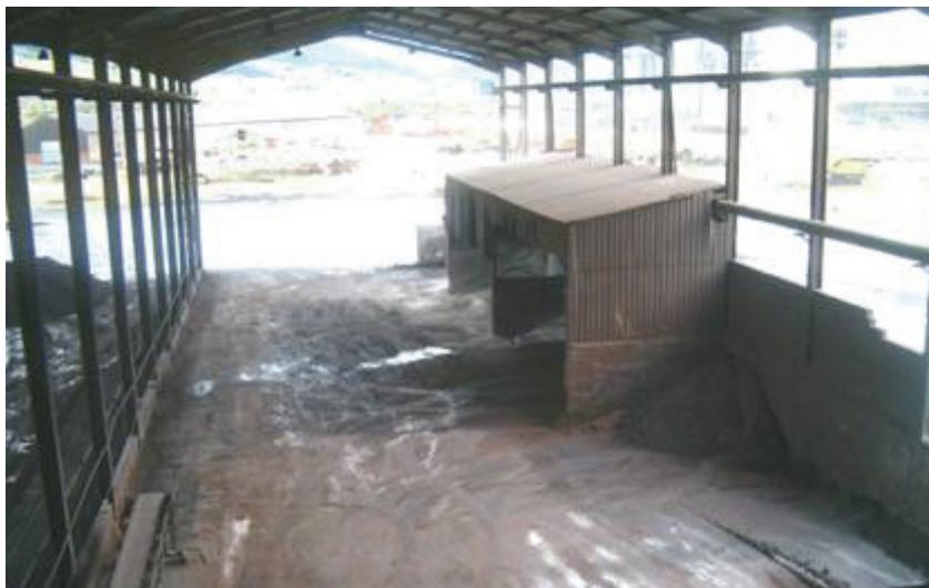
**Figura 1 Boxes: Zona de descarga de lodos y polvos para su premezcla**
