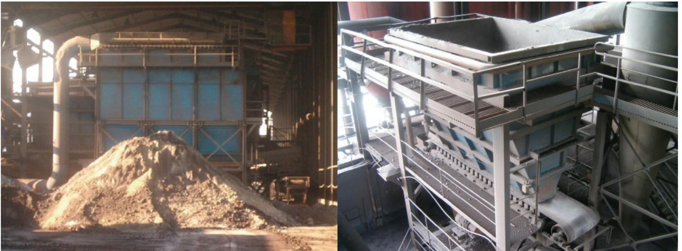
**Figura 3 Premezcla de material, calamarro de carga y tolva de carga del material a la entrada del proceso**
