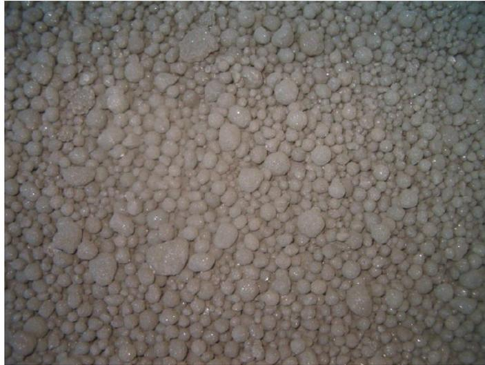
**Figura 6 Pellets producidos destino Sinter**
